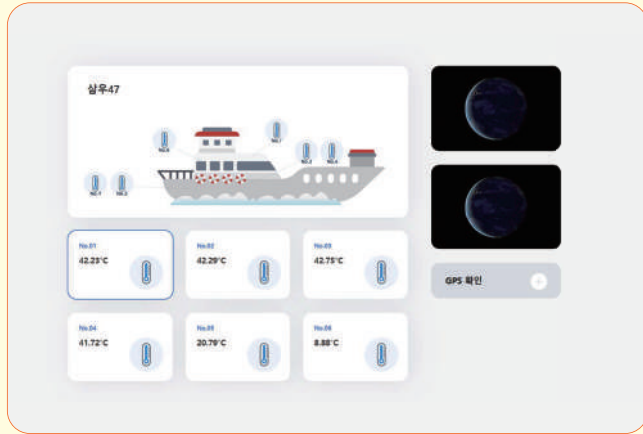
한국해양교통안전공단 선박 모니터링 IoT 홈페이지 (선박 연동 센서 실시간 갱신 및 모니터링, CCTV 및 GPS, 구글맵스 연동)
